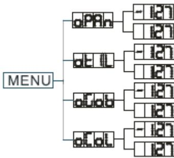
Um das Menü für die Einstellung der Startposition zu öffnen, betätigen Sie die ENTER-Taste für mindestens 5 Sekunden. In diesem Untermenü können Sie die ursprüngliche Position der Schwenkung, Neigung, des Farbrads und des Gobarads einstellen.
